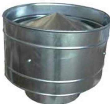
Дефлектор – вентиляционное аэродинамическое устройство расчётной формы и размера для усиления тяги естественной вытяжки. Дефлекторы служат для создания естественной тяги за счет теплового и ветрового напора. Ветер, набегая на дефлектор, создает внутри цилиндрической оболочки зону пониженного давления, способствующего работе вытяжной системы.
